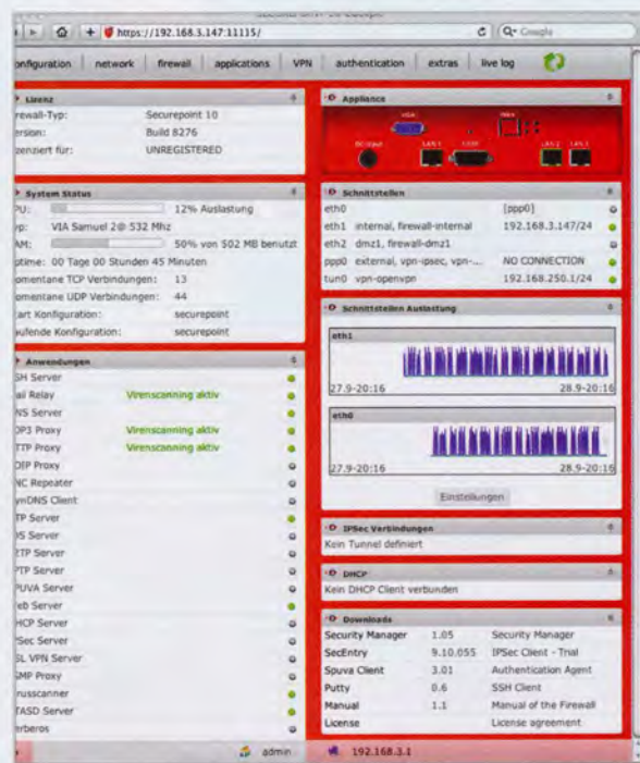
Das per Webbrowser zugängliche Securepoint-Cockpit zeigt auf einen Blick alles Wissenswerte über den Zustand der UTM-Appliance.
