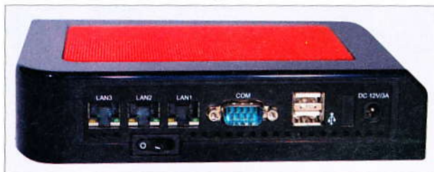
◀ Abbildung 1: An seiner Rückseite bietet der schwarze Zwerg Anschlüsse für DSL-Modem, LAN und DMZ sowie einen seriellen und zwei USB-Ports.
