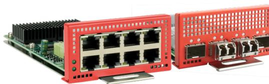
Diese UTM-Firewall der Enterprise-Klasse verfügt auf der Vorderseite über zwei Einschübe, um Erweiterungskarten aufnehmen zu können. Zur Auswahl stehen Karten mit **8-Port 1 GBit/s Ethernet (RJ-45)** und **4-Port GBIC für SFP+ 10 GBit/s Module (SR oder LR)**.
