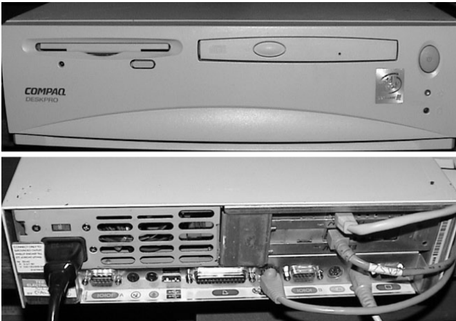
Abbildung 16.12: Dieser ältere PC (Pentium III, 450 MHz) mit drei Netzwerkkarten ist ideal für eine Securepoint-Firewall, die ein kleines LAN absichern soll.
