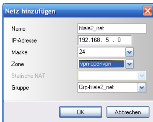
Abb. 15 Objekt für Filialen Netz anlegen
